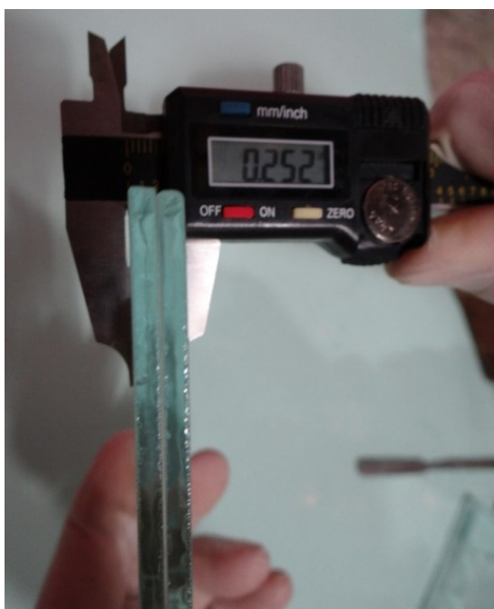
Figura 3 – Paquímetro digital conferindo espessura das placas com cimento interposto Fonte: Autoria própria.
