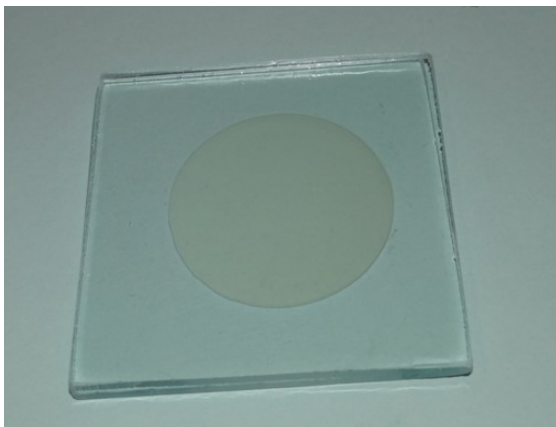
Figura 2 – Cimento interposto entre as placas de vidro Fonte: Autoria própria.
